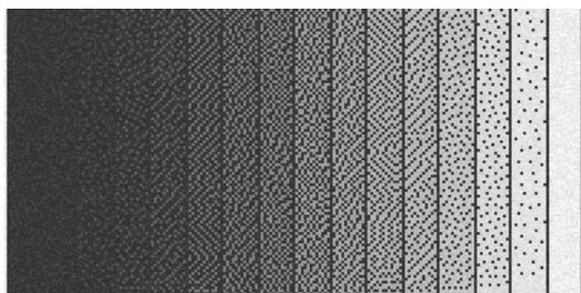
Для тестирования и настройки станка используется гравировка цветового клина (см. рис.14.3). Цветовой клин позволяет проверить и отрегулировать правильность гравировки отдельных полутонов.
