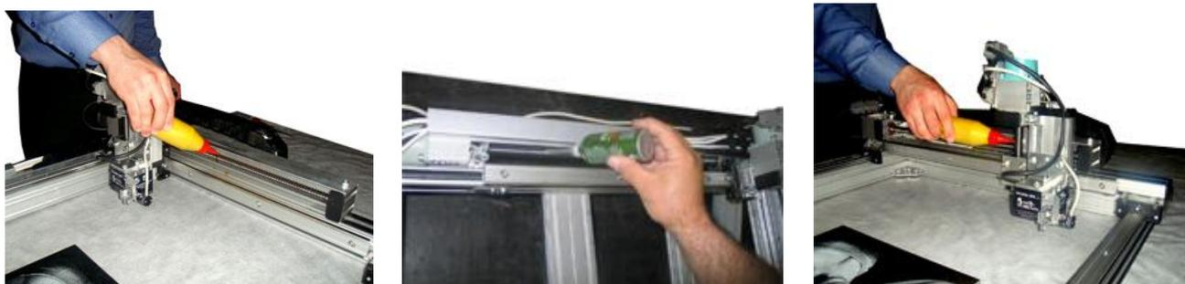
Рис.15.2. Смазка винтов приводов X, Y, Z.
