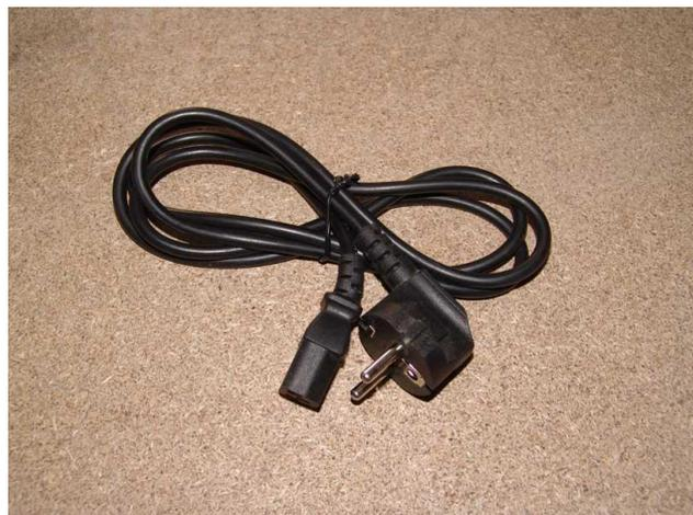
Рис. 4.3. Кабель питания с заземлением.
