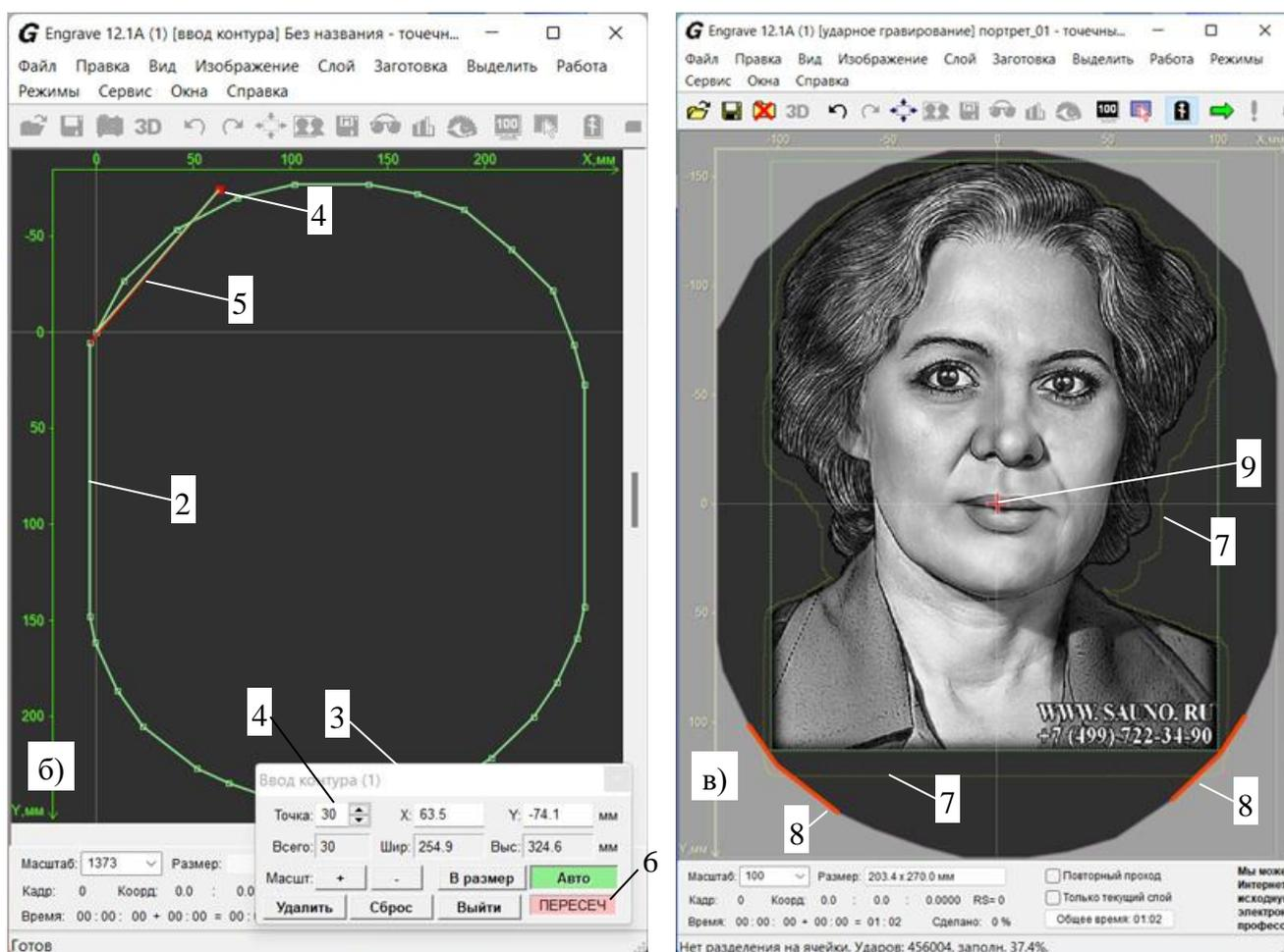
Рис.14.5. Заготовка (а), экран ввода контура (б) и размещение изображения по форме заготовки (в).
