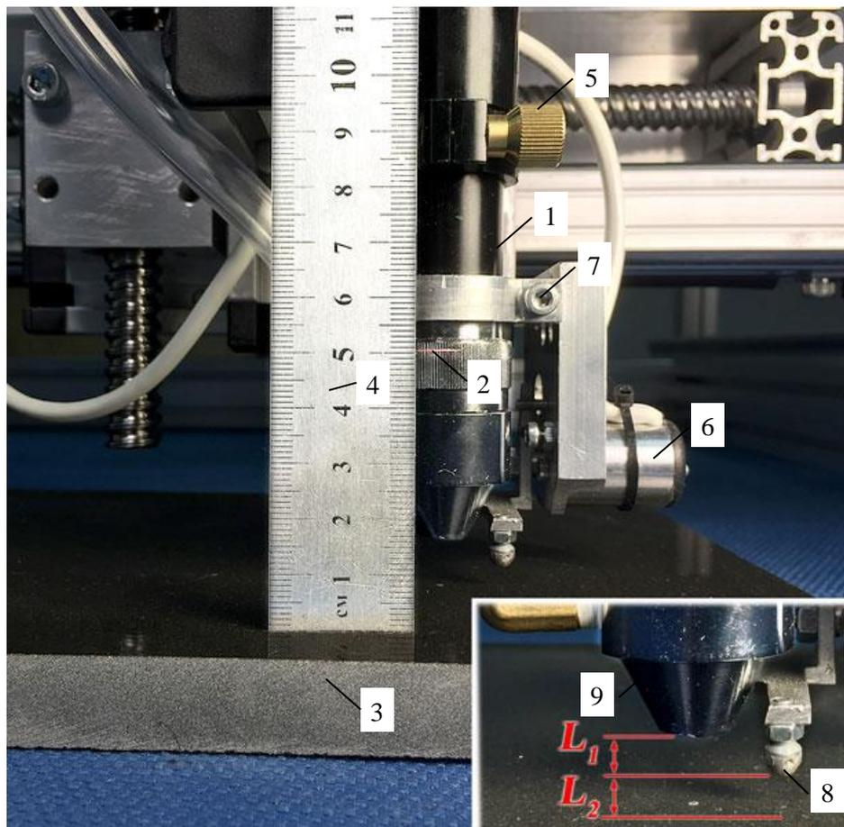
1. Объектив лазерной головки.
