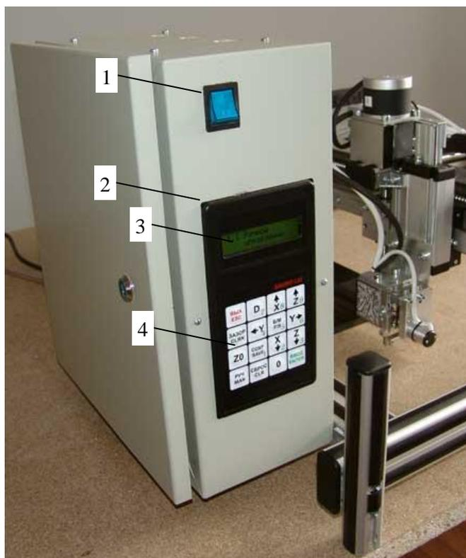
Рис. 3.6. Микропроцессорный блок управления.
