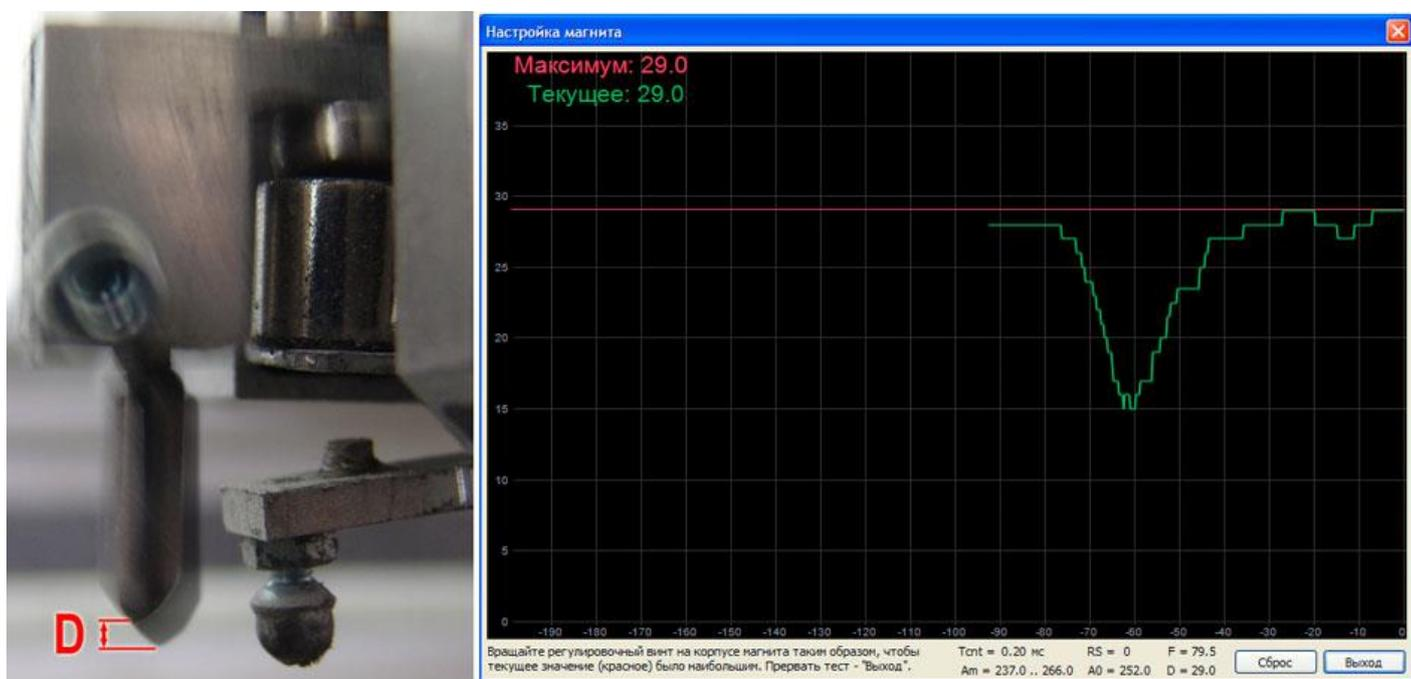
Рис. 17.2. Окно настройки электромеханического виброгенератора в программе *Engrave*.
