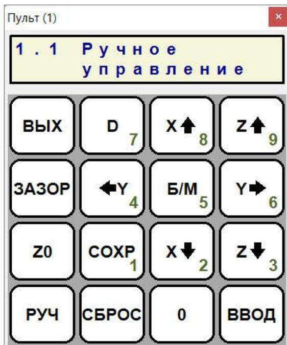
Пульт ручного управления программы *Engrave* (рис.14.4) дублирует пульт управления станком. Он может быть полезен в ситуации, если вы управляете станком с удаленного компьютера.
