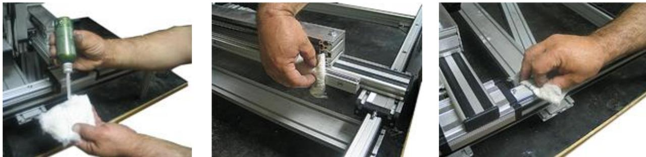
Рис.15.1. Смазка направляющих.
