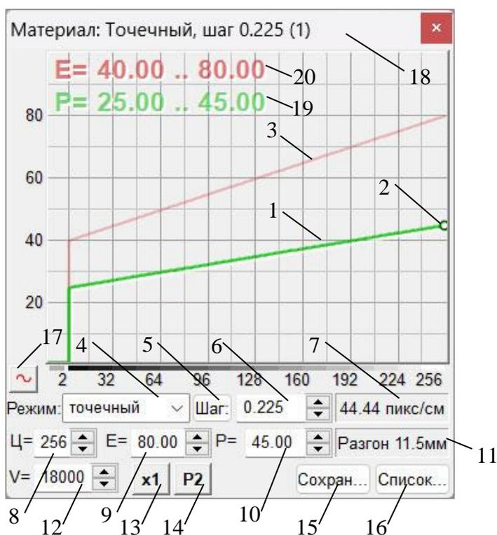
Рис. 7.2. Панель «Материал» в лазерном режиме (растровая гравировка).
