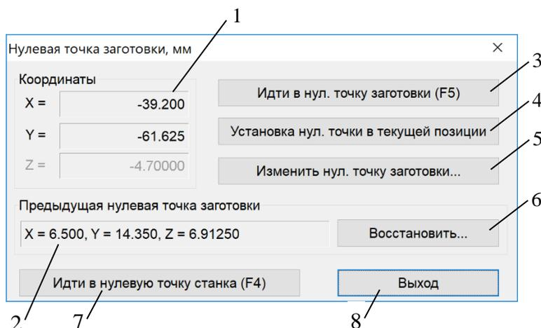
1. Координаты нулевой точки заготовки.
